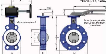
Габаритные размеры дисковых поворотных затворов с мягким седловым уплотнением серии SBE, мм
