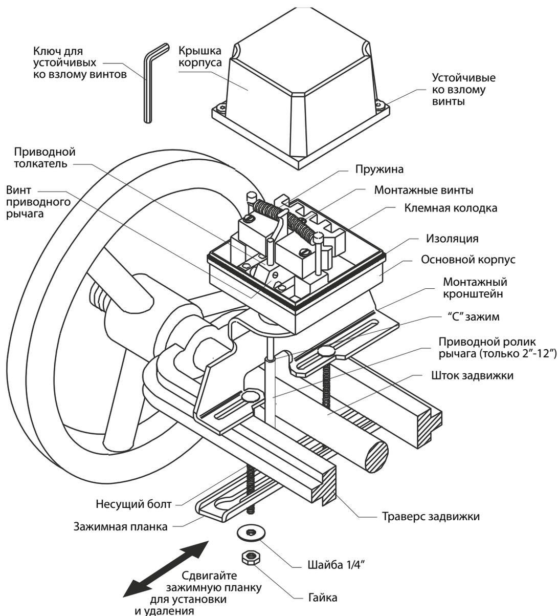
Схема подключения контрольного выключателя:
